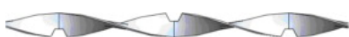
รูปที่ 18 ใบบิดชนิดมีร่องสี่เหลี่ยมคางหมู [20]
