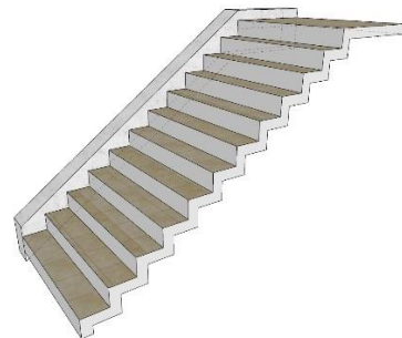
รูปที่ 1 รูปแบบบันได คสล.แบบยื่น
