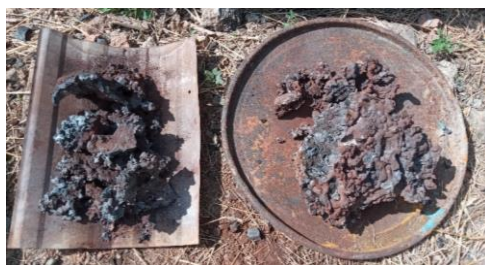
รูปที่ 9 (1) ตะกรัน (Slag) (2) เหล็กอ่อนบริสุทธิ์ (Wrought Iron) ที่ได้หลังการถลุง
