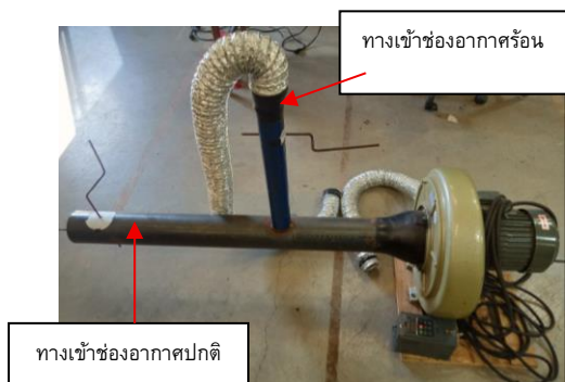
รูปที่ 4 ช่องทางดึงอากาศเข้าสู่ห้องปฏิกรณ์ของเตาถลุงชั้นที่ 2
