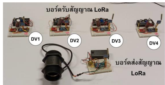
รูปที่ 8 ลักษณะการประกอบติดตั้งอุปกรณ์บอร์ดส่งและรับสัญญาณ LoRa
