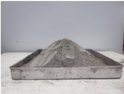
รูปที่ 7 ปูนซีเมนต์ปอร์ตแลนด์ประเภทที่ 1 (OPC)
