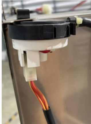
รูปที่ 11 สวิตช์วัดระดับน้ำ
