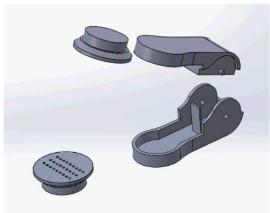
รูปที่ 1 การออกแบบอุปกรณ์สร้างอักษรเบรลล์
