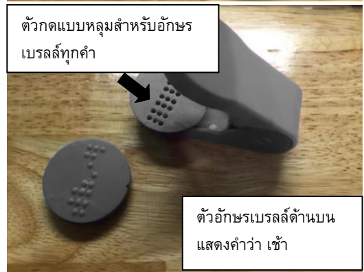
รูปที่ 3 การประกอบอุปกรณ์สร้างอักษรเบรลล์
