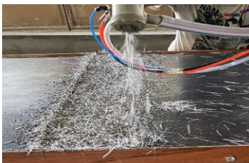
รูปที่ 1 การเตรียมตัวอย่างแผ่นบางจะใช้วิธีการพ่น
