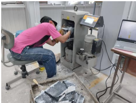
รูปที่ 13 การทดสอบการรับแรงอัดคอนกรีตบล็อก
