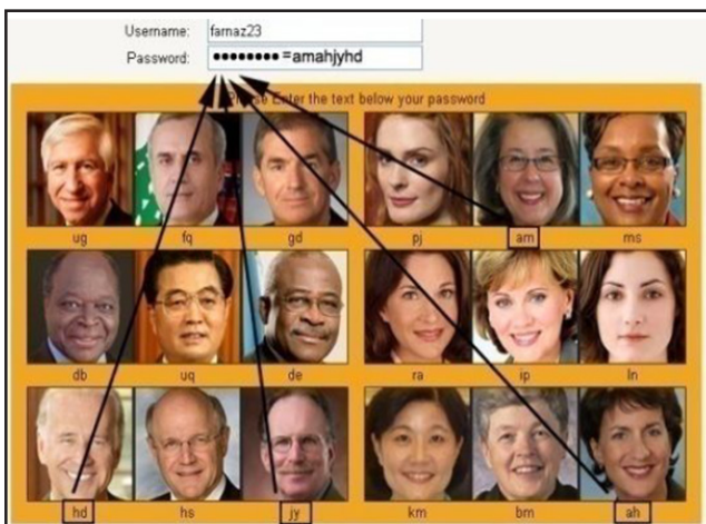
ภาพที่ 2 การพิสูจน์ตัวตนครั้งแรกด้วย S-Passface [14]
