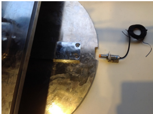
รูปที่ 3 อุปกรณ์วัดรอบโดย Proximity transducer
