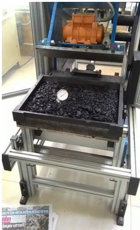
รูปที่ 9 วัสดุผสมที่นำมาทดสอบในแบบก่อนการบดอัด
