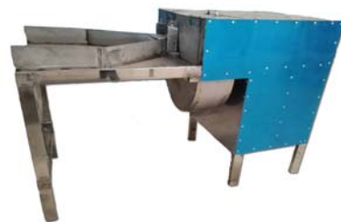
รูปที่ 4 เครื่องหันฟ้าทะเลลายโจรที่ผู้วิจัยสร้างขึ้น
