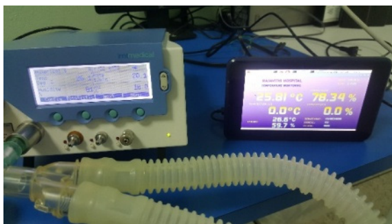
รูปที่ 7 การทดสอบเทียบค่ากับเครื่อง Gas Flow Analyzer
