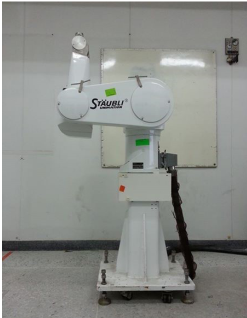
รูปที่ 1 หุ่นยนต์แขนกลอุตสาหกรรม Staubli RX 90
