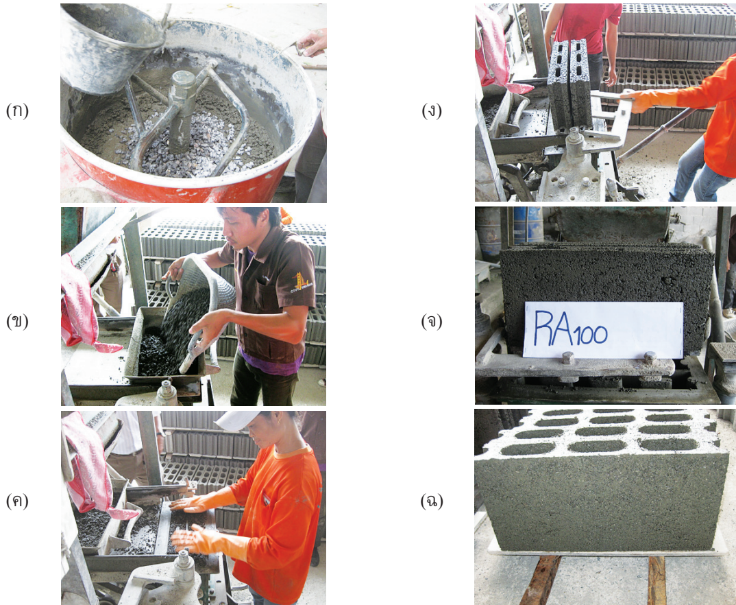
รูปที่ 3 ขั้นตอนการขึ้นรูปชิ้นงานตัวอย่าง (ก) ผสมวัสดุลงในโม่ผสม (ข) นำคอนกรีตใส่ในเครื่องหล่อคอนกรีตบล็อกขนาด 7 \times 19 \times 39 ซม. (ค) ปรับระดับคอนกรีตสดก่อนขึ้นรูป (ง) การอัดขึ้นรูปเป็นคอนกรีตบล็อก (จ) คอนกรีตบล็อกหลังขึ้นรูปเสร็จก่อนนำไปบ่ม (ฉ) คอนกรีตบล็อกที่พร้อมใช้งาน
