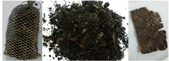
รูปที่ 2 ตัวอย่างชิ้นงานในการทดสอบการย่อยสลายทางชีวภาพโดยการฝังดินของฟิล์มคอมโพสิตชีวภาพ
