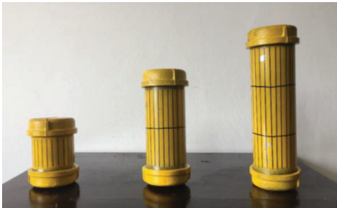
รูปที่ 1 ท่อเหล็กที่ใช้ในการทดสอบ จากซ้ายไปขวาสูง 100, 200 และ 300 มิลลิเมตร
