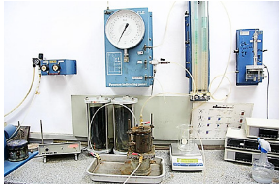
รูปที่ 1 การทดลองการหาค่าการซึมผ่านของน้ำในดิน
