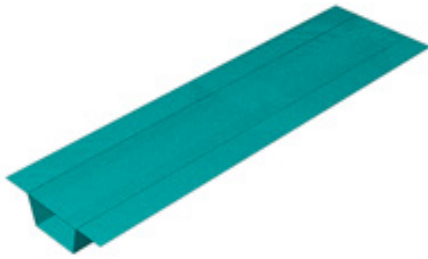
รูปที่ 4 ตัวอย่างรูปร่างของแบบจำลองสะพานแบบระเบียบวิธีไฟไนต์เอลิเมนต์ (Finite Element Method)
