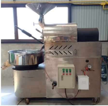
รูปที่ 3 เครื่องคั่วเมล็ดกาแฟประเภท Drum Roasters
