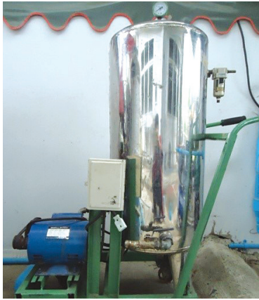
รูปที่ 3 ชุดปั๊มลมพร้อมถังสำหรับเก็บก๊าซชีวภาพจากบ่อหมัก
