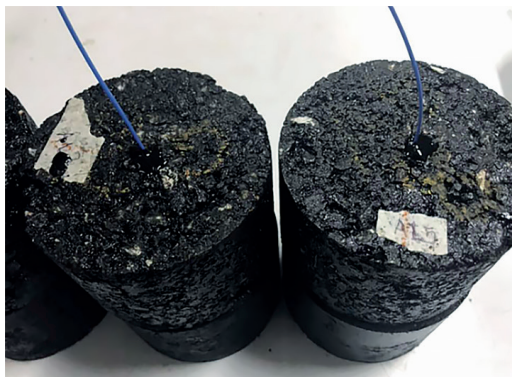
รูปที่ 2 การติดตั้งเครื่องวัดอุณหภูมิในก้อนตัวอย่าง
