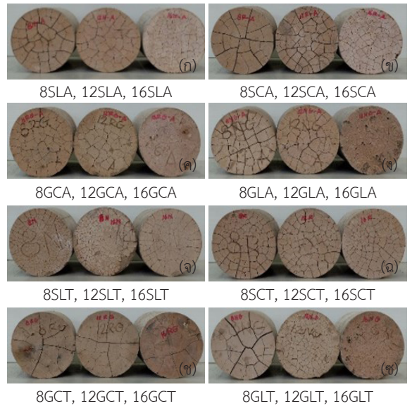
รูปที่ 7 ผิวตัวอย่างหลังจากการเผาที่อุณหภูมิ 600 องศาเซลเซียส
