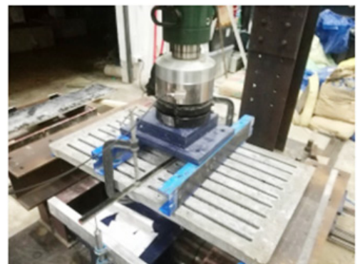
รูปที่ 9 การให้น้ำหนักบรรทุก อุปกรณ์ตรวจวัดทางเทคนิค และรายละเอียดพื้นทดสอบ (หน่วยเป็น มม.)
