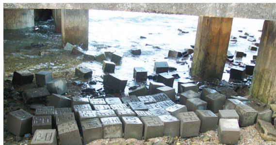
รูปที่ 1 ตัวอย่างคอนกรีตที่แช่บริเวณชายฝั่งทะเล จ.ชลบุรี
