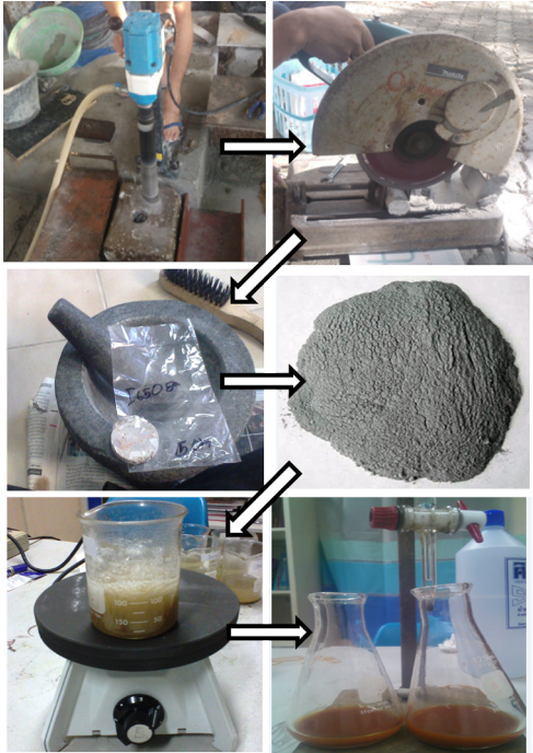
รูปที่ 2 การทดสอบปริมาณคลอไรด์ในคอนกรีต
