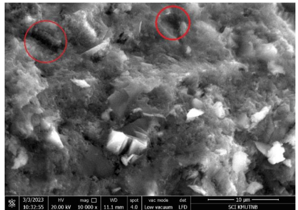
รูปที่ 12 โครงสร้างจุลภาคของคอนกรีตมวลเบา (OPC)
