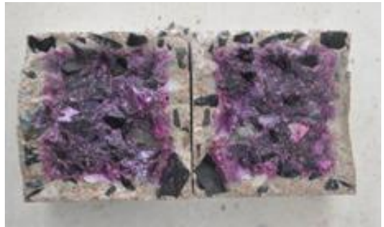
รูปที่ 2 ตัวอย่างผลของก่อนตัวอย่างคอนกรีตที่ผาซีก หลังจากแช่ในตู้อบแล้วทำการทดสอบการเกิดคาร์บอนเนชั่น บริเวณเนื้อคอนกรีตที่ไม่เป็นสีม่วงเป็นบริเวณเกิดคาร์บอนเนชั่น
