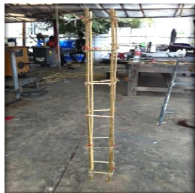
รูปที่ 2 ไม้ไผ่ใช้เป็นโครงสร้างแทนเหล็กเสริม
