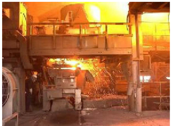
รูปที่ 13 กระบวนการเทเหล็กเหลวออกจากเบ้าหลอม
