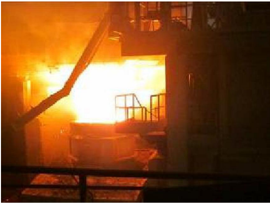
รูปที่ 12 การหลอมเหล็กเหลวโดยใช้เศษเหล็กลงในเตาหลอมอาร์คไฟฟ้าที่อุณหภูมิร้อนประมาณ 700 °C
