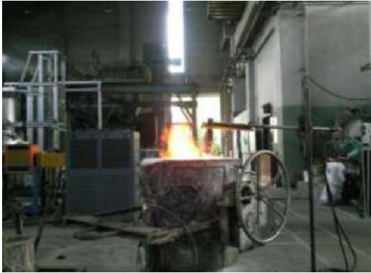
รูปที่ 1 เตาหลอมอาร์คไฟฟ้า ในขณะที่การอุ่นเบ้ารับน้ำเหล็กที่ขนาดความจุ 1 ตันน้ำเหล็ก [5]
