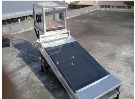
รูปที่ 1 ชุดทดลองประกอบด้วยตู้อบแห้งและตัวเก็บรังสีอาทิตย์แบบแผ่นราบ
