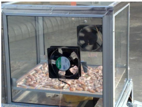
รูปที่ 3 ปลายหมึกกะต๋อยสดตากในตู้อบแห้งและมีอากาศ ร้อนจากตัวเก็บรังสีอาทิตย์ไหลผ่าน
