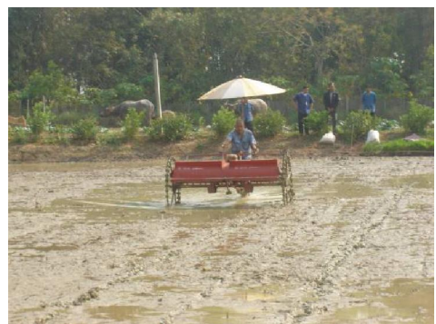
รูปที่ 2 เครื่องหยอดเมล็ดพันธุ์ข้าวขนาดมขณะใช้งานในพื้นที่แปลงนาสาธิต [7]
