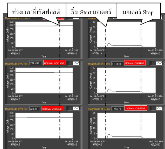
รูปที่ 12 หน้าจอแสดงการทำงานของมอเตอร์ และหยุดการทำงานเมื่อตรวจพบความผิดปกติจากฟอลต์ภายในด้วยสถานะตัวนำเตเตอร์ลัดรอบ 4%
