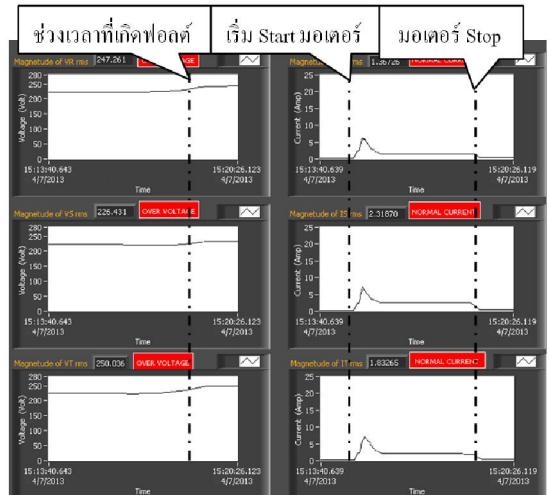
รูปที่ 11 หน้าจอแสดงการทำงานของมอเตอร์ และหยุดการทำงานเมื่อตรวจพบความผิดปกติจากฟอลต์ภายนอกด้วยสถานะแหล่งจ่ายแรงดัน 3 เฟสมีค่าสูงกว่าปกติ 6 %PVUR
