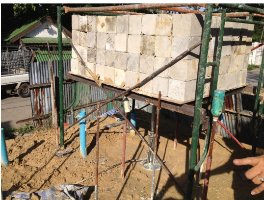
รูปที่ 6 การใช้ลูกปูนเป็นน้ำหนักด้านบน
