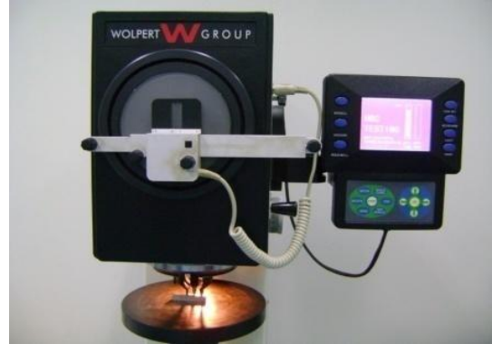
รูปที่ 4 เครื่องทดสอบความแข็งแบบร็อคเวลล์
