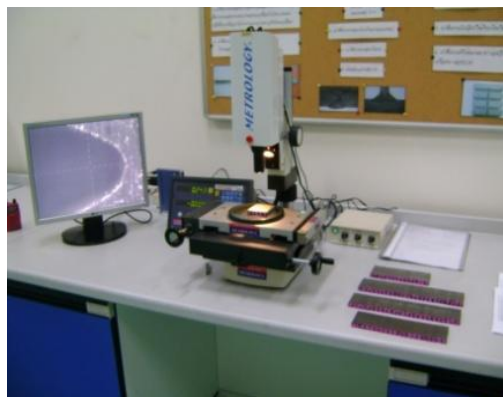
รูปที่ 8 กล้องขยาย micro scope สำหรับวัดขนาดร่องบาก
