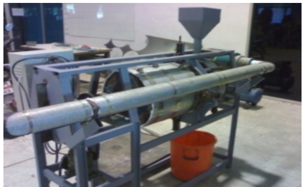
รูปที่ 2 เครื่องอบแห้งแบบถังทรงกระบอกหมุน
