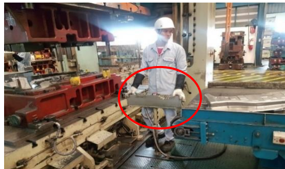
รูปที่ 7 ตำแหน่งของปั๊มแฮนด์สวิตช์หลังปรับปรุง
