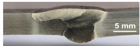
รูปที่ 12 โครงสร้างมหภาคของชิ้นงานเชื่อมด้วยโลหะเติม AWS A5.14 ERNiCrMo-3
