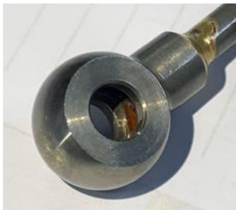
รูปที่ 3 ปัญหาสนิมที่เกิดขึ้นที่บริเวณข้อต่อท่อน้ำมันของ Part No. A1609
