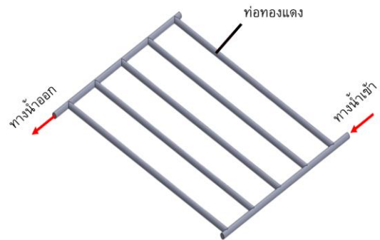
(ข) แสดงทางน้ำเข้าและทางน้ำออกของท่อทองแดง
