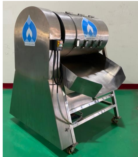
รูปที่ 3 เครื่องขูดเกล็ดปลาที่นำเสนอ
