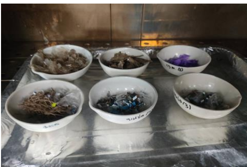
รูปที่ 5 การอบขยะมูลฝอยหาค่าความชื้น
