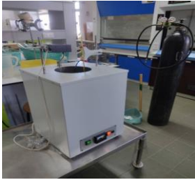
รูปที่ 4 การวิเคราะห์ค่าความร้อนโดยบอมม์แคลอรีมิเตอร์
