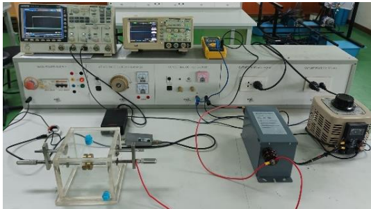
รูปที่ 10 วงจรจริงที่ใช้ในการทดลองดิสชาร์จบางส่วน
