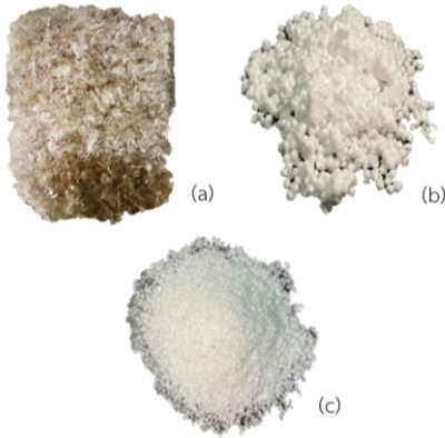
รูปที่ 2 (a) ขยะ PS (b) EPS ภายหลังจากการลดขนาดด้วยเครื่อง Shredder และ (c) PS ภายหลังจากการบดให้เป็นผงด้วยเครื่อง Powderizer
