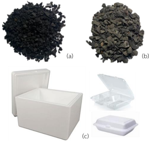
รูปที่ 1 (a) เศษยางล้อยืดที่ผ่านการบดย่อย (b) หินย่อย และ (c) บรรจุภัณฑ์ PS และ EPS
