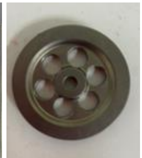
ง) ชิ้นงานลูกล้อหลังเจาะรู 1 ชิ้นต่อรอบการทำงาน
