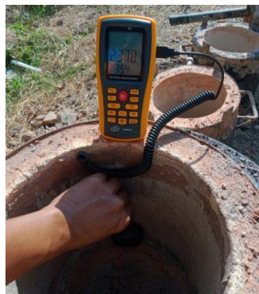
รูปที่ 6 การวัดอัตราการไหลของอากาศเข้าสู่ชั้นปฏิกรณ์ของเตาถลุงด้วยเครื่อง (Air Flow Anemometer) รุ่น GM8902
