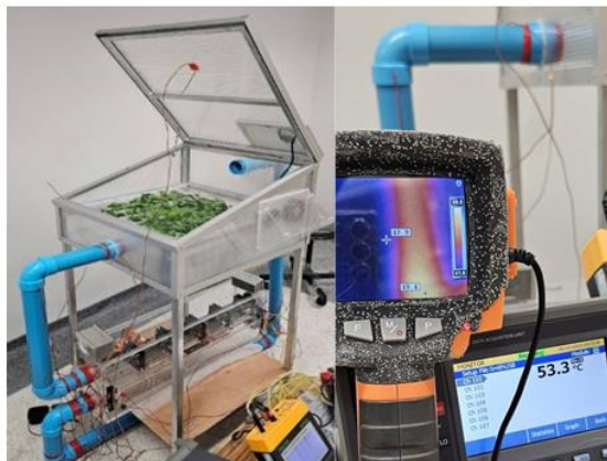
รูปที่ 11 ภาพถ่ายการทดลองอบแห้งใบมะรุม และการวัดอุณหภูมิของท่อหมุนวนอากาศ
