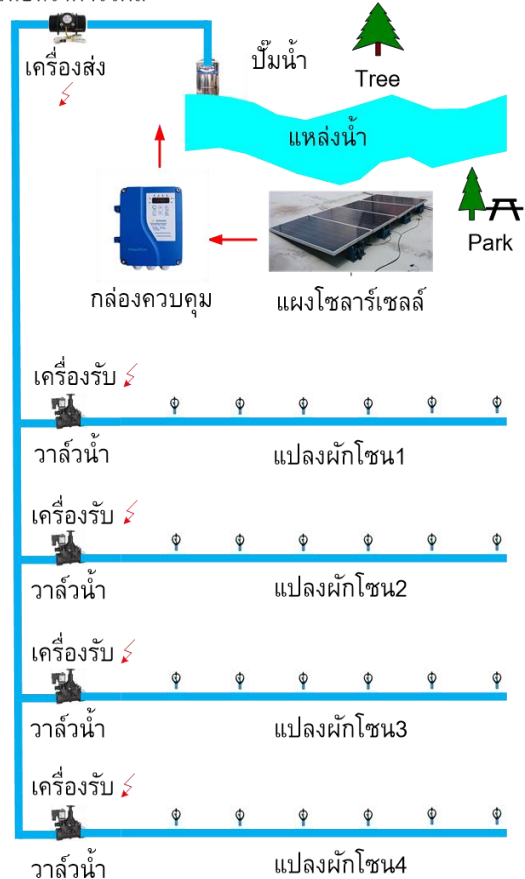
รูปที่ 1 โครงสร้างระบบโดยรวม
