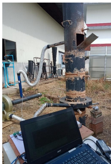
รูปที่ 7 การประกอบ/ติดตั้งเพื่อทดสอบประสิทธิภาพเตาถลุงแร่เหล็กแบบเผาตรง
