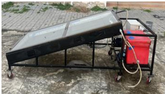
รูปที่ 9 เครื่องทำน้ำร้อนระบบไฮบริด
