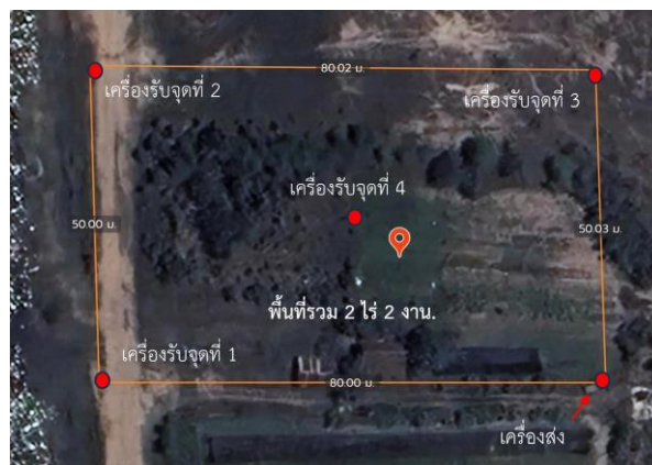
รูปที่ 18 การจัดวางการทดลองระยะรับส่งสัญญาณควบคุมหัวน้ำ
