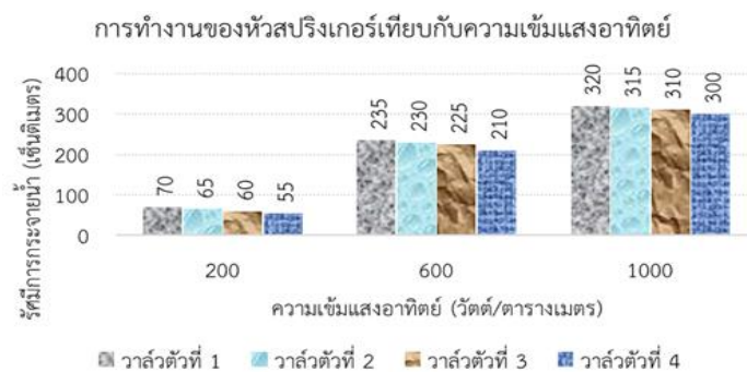
รูปที่ 17 รังสีการกระจายน้ำผ่านหัวน้ำแต่ละตัว
