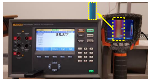
รูปที่ 6 ตัวอย่างการวัดอุณหภูมิ ด้วยเครื่องบันทึกและกล้องถ่ายภาพความร้อน
