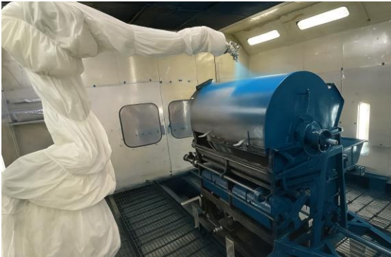
รูปที่ 2 กระบวนการพ่นสีเครื่องนวดข้าวด้วย Robot
