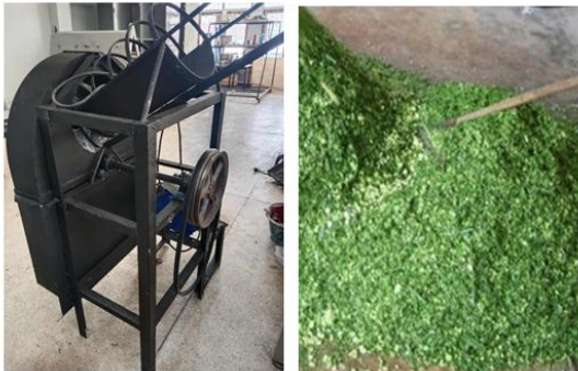
รูปที่ 10 เครื่องย่อยหญ้าเนเปียร์และผ่านการย่อย
