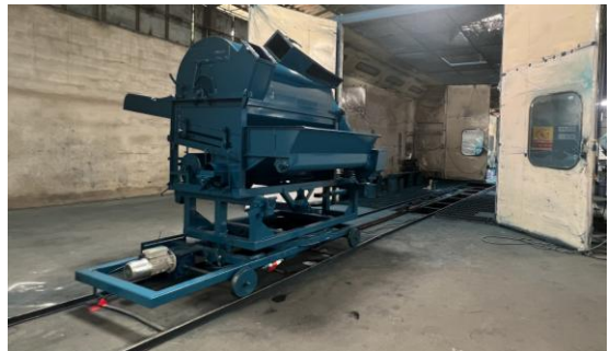
รูปที่ 10 การทดสอบระบบและเก็บข้อมูลการทำงานของอุปกรณ์จับยึด (Fixture)
