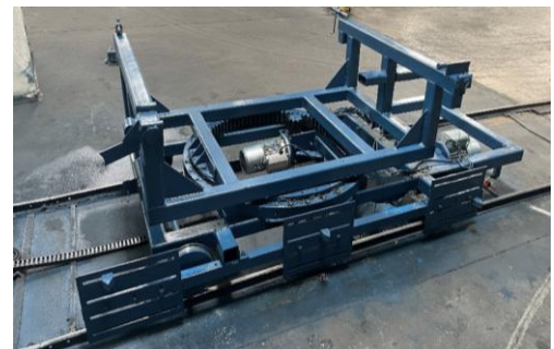
รูปที่ 8 อุปกรณ์จับยึด (Fixture) เครื่องนวดข้าวแบบเคลื่อนที่อัตโนมัติที่แล้วเสร็จ
