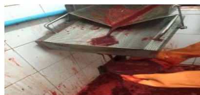
รูปที่ 13 การรองเลือดหลังติดตั้งเครื่องกวาดเลือด
