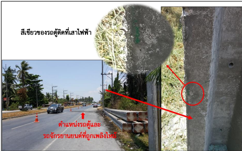
รูปที่ 4 ร่องรอยการกระแทกและตำแหน่งเพลิงไหม้ของรถตู้
