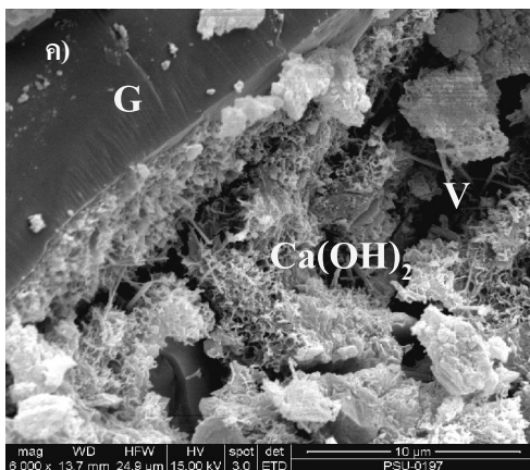
รูปที่ 12 ภาพถ่ายจุลทรรศน์อิเล็กตรอนแบบส่องกราดของโครงสร้างภายในคอนกรีตมวลรวมเศษขวดแก้วกำลังขยาย ก) 5,000 เท่า ข) 6,000 เท่า และ ค) 6000 เท่า
