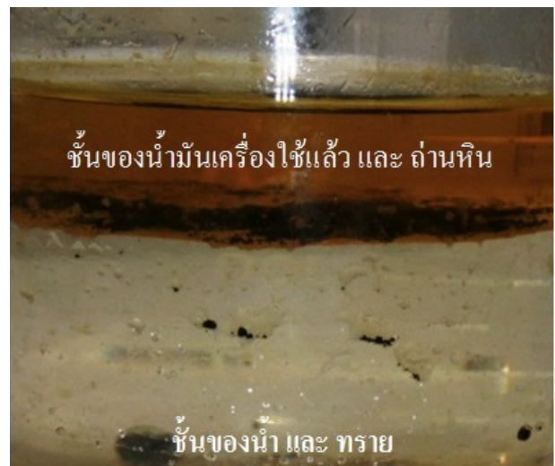
รูปที่ 7 ชั้นของน้ำมันเครื่องใช้แล้วที่แยกออกจากชั้นน้ำ
