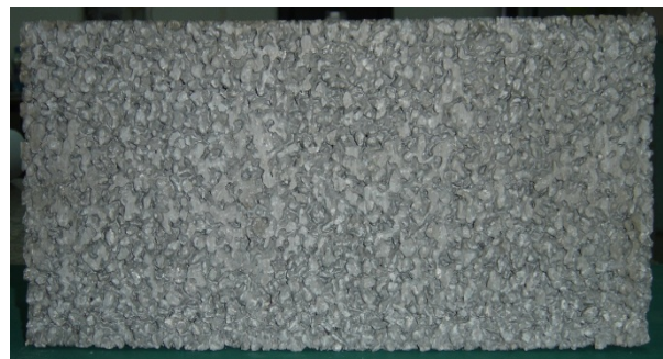
รูปที่ 5 ลักษณะของคอนกรีตบล็อกพรุน ชุดทดสอบที่ 8
